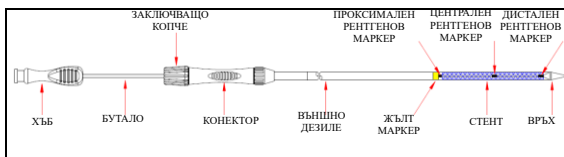
Фигура 1. Интродюсерна система тип TTS
