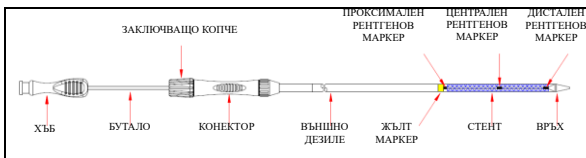
Фигура 2. Интродюсерна система (Интродюсер TTS)
